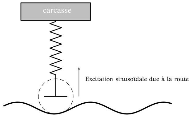
On peut simplifier le problème en ne considérant que le déplacement vertical de la voiture. Cette situation est équivalente à celle de la masse suspendue à un ressort et stimulée sinusoidalement.
