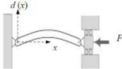
On se propose d'étudier la déformation élastique  $d$  par flambement d'une poutre arquée. On soumet cette poutre à une force longitudinale d'intensité  $F$ , conformément au schéma ci-dessus. On montre que la déformation élastique  $d$  qu'elle subit est solution de l'équation différentielle suivante :
